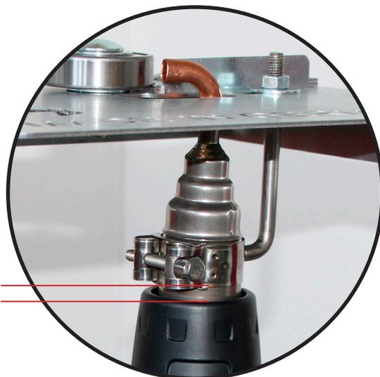
Inoltre è possibile regolare la posizione della pistola ad aria calda nella parte superiore della piastra di saldatura. Allentare il dado con la chiave combinata da 13mm (n. **2**). Regolare la posizione della pistola ad aria calda lungo la scanalatura e serrare nuovamente il dado a mano.
