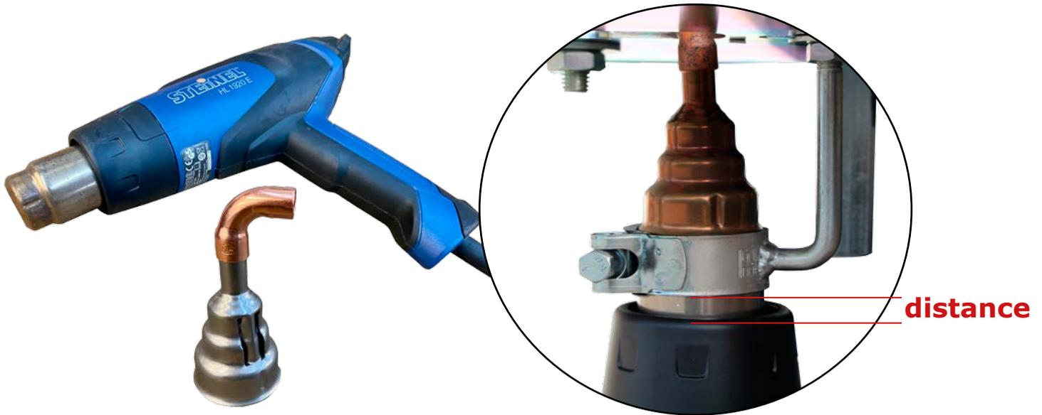
V. Vous pouvez aussi varier la position du pistolet à air chaud à la surface du plateau de soudure. Utilisez la clé mixte de 13mm (n° 3) pour desserrer l'écrou. Repositionnez le pistolet au long du trou et resserrez l'écrou à la main.
