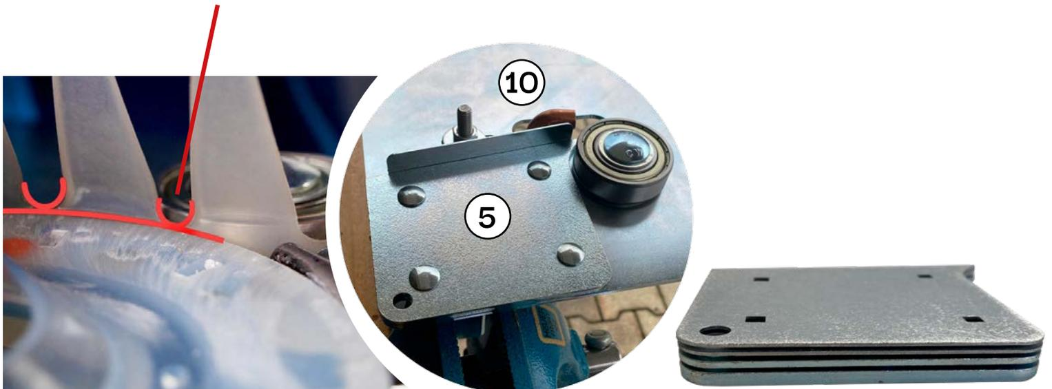
IV. Placez la buse (n° 4) sur votre pistolet à air chaud (veuillez voir n° 4). Positionnez le pistolet dans le dispositif de fixation du plateau de soudure (n° 10). Utilisez la clé à fourche de 10mm (n° 3) pour fixer le pistolet. Serrez la vis à la main.
